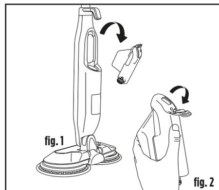
3. Prima di riempire il serbatoio dell'acqua, scollegare la scopa a vapore Steam & Scrub dalla presa elettrica. Per rimuovere il serbatoio dell'acqua, estrarlo allontanandolo dal corpo della scopa. Tirare indietro il tappo di gomma e riempire il serbatoio **SOLO** con acqua fredda o a temperatura ambiente.
