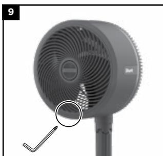
9. Posizionare il ventilatore in piedi su una superficie piana e livellata. Utilizzare l'estremità con testa a croce della **chiave a brugola** per serrare la vite sulla parte inferiore della **Griglia**.
