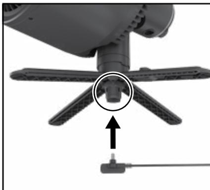
**MODALITÀ DA TAVOLO:** per caricare il ventilatore in modalità da tavolo, inserire il caricabatterie nella porta di ricarica che si trova sotto l'asse centrale del ventilatore, tra i 4 piedi di supporto. **NON RICARICARE O UTILIZZARE SOTTO LA PIOGGIA.**
