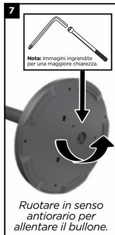
7. Posizionare la base del piedistallo su un lato per accedere al bullone sulla parte inferiore. Utilizzare la chiave a brugola in dotazione per ruotare il bullone in senso antiorario, quindi rimuovere il bullone.
