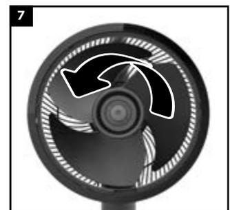
7. Reinstallare il tappo della ventola. Riavvitare il tappo in senso antiorario per reinstallarlo sull'asta, tenendo la ventola in posizione.
