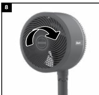
8. Ruotare la **Griglia** in senso orario per fissarla alla testa del ventilatore.
