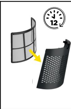
1. Rimuovere il pannello antipolvere dall'unità tirando delicatamente la linguetta. Nota - Non è necessario rimuovere il filtro a retino dal pannello antipolvere.
